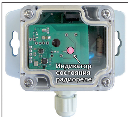
Рисунок 4. Расположение индикатора состояния радиореле.
